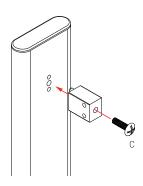
Avvitare i connettore con le viti metriche (C) ai montanti verticali.
